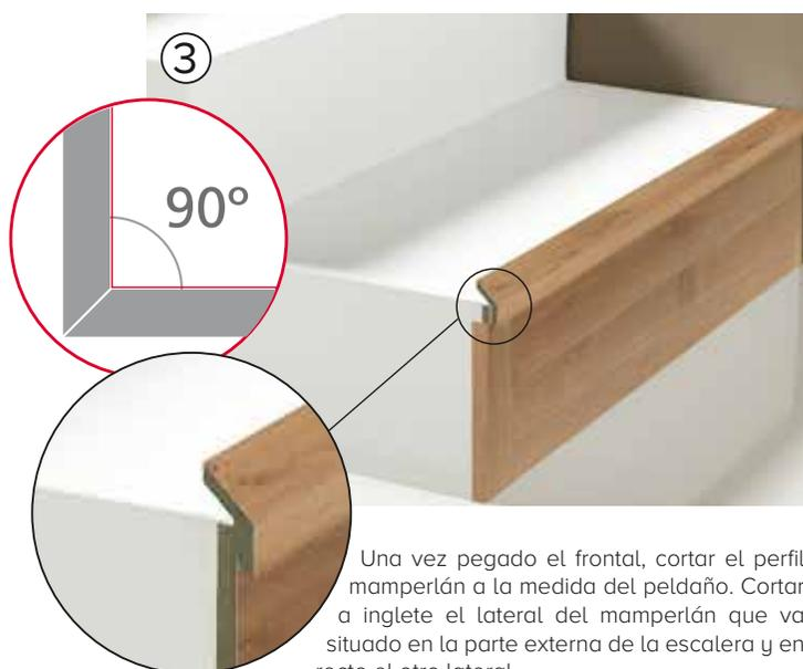
Una vez pegado el frontal, cortar el perfil mamperlán a la medida del peldaño. Cortar a inglete el lateral del mamperlán que va situado en la parte externa de la escalera y en recto el otro lateral.
