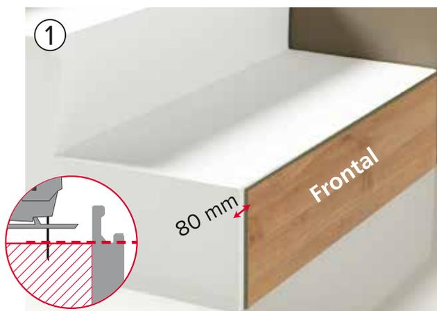
Con la superficie seca y nivelada, cortar el suelo FAUS a la medida de la contrahuella (Frontal) restándole 90 mm (medida del mamperlán) y cortar el macho y la hembra de los 4 lados.
